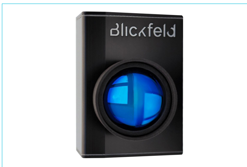
Obrázok 17. Firma Blickfeld vyrába lidarový snímač s označením Cube Range, ktorý rozpoznáva prekážky až do vzdialenosti 250 metrov. 3D lidar v pevnej fáze disponuje dosahom 150 metrov pri 10-percentnej odrazivosti, dosah až do 250 metrov je možný pri vyššej odrazivosti; rozlíšenie je 0,18°. Produkt používa zrkadlo MEMS z kremíka. Husté 3D mračno bodov v reálnom čase spracúva softvérový zásobník. Snímač je vhodný pre jazdy diaľničnou rýchlosťou. (Obrázok: tlačový obrázok Blickfeld GmbH)
