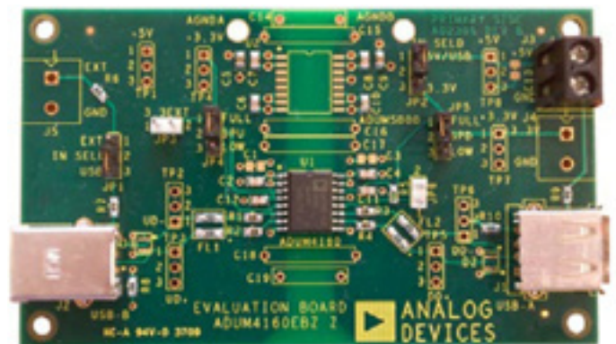
Bild 2. Entwicklungsboard für den IEC 60601-1-konformen ADuM4160 Digital-Isolator-iCoupler . Er ermöglicht eine Isolierung von Peripheriegeräten in USB-Anwendungen (Bild: RS Components)
