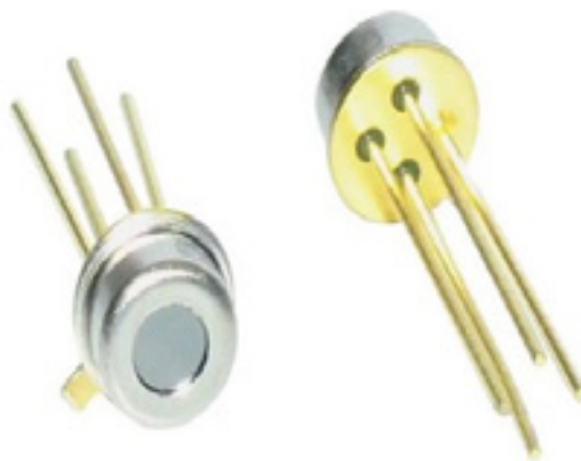
Bild 13. Die Thermosäulen befinden sich in hermetisch abgedichteten Gehäusen der Größe TO-5 oder TO-18. (Bild: RS Components)
