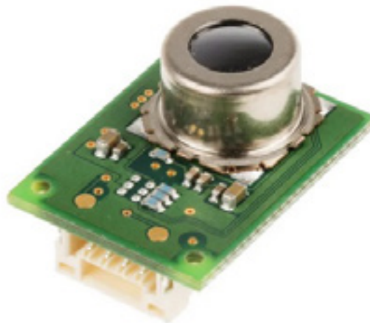
Bild 12. Die thermischen MEMS-Sensoren (Micro-Electro-Mechanical-Systems) Omron D6T verwenden eine spezielle ASIC-Technologie, um die nötige Störfestigkeit zu erreichen. (Bild: RS Components)
