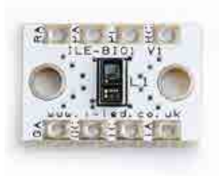
Bild 22. Die Platine BIOFY Eco1 SFH 7050 verfügt über Befestigungsbohrungen für M3-Schrauben und hat Abmessungen von 20,25mm x 13,7mm x 0,9mm. (Bild: RS Components)
