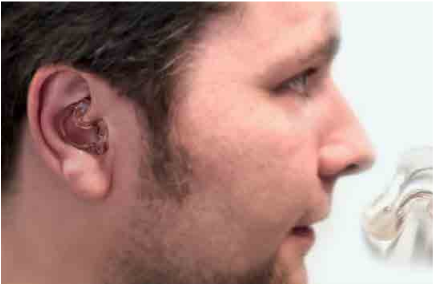
Bild 18. Der In-Ohr-Sensor für das nicht-invasive Schlag-zu-Schlag-Blutdruckmonitoring (Bild: Nadin Jurisch, Pressebild CiS Forschungsinstitut)
