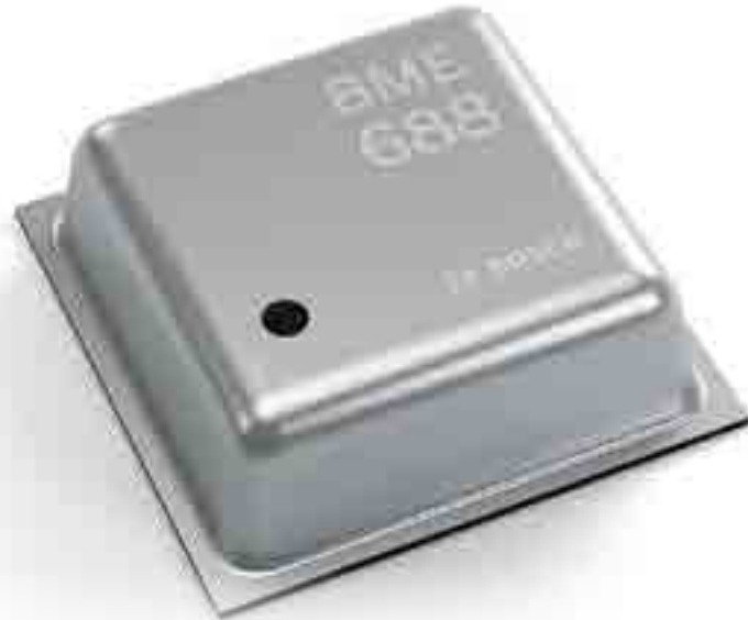
Bild 15. Der B680 befindet sich in einem LGA-Gehäuse mit Abmessungen von 3mm x 3mm x 0,93mm mit 8-poligem Metalldeckel. (Bild: RS Components)
