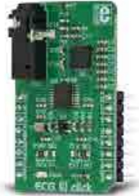
Bild 4. Die Click-Platine ist für den Einsatz auf einem System mit mikrobus-Anschluss geeignet und dient dem Prototyping. (Bild: RS Components)
