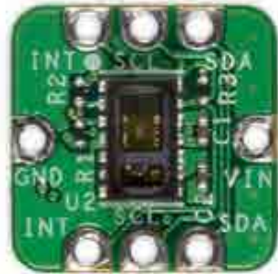
Bild 21. Die optische Herzfrequenzmonitor- und Pulsoximetrie-Lösung befindet sich auf einer Platine mit den Abmessungen 12,7mm x 12,7mm. (Bild: RS Components)
