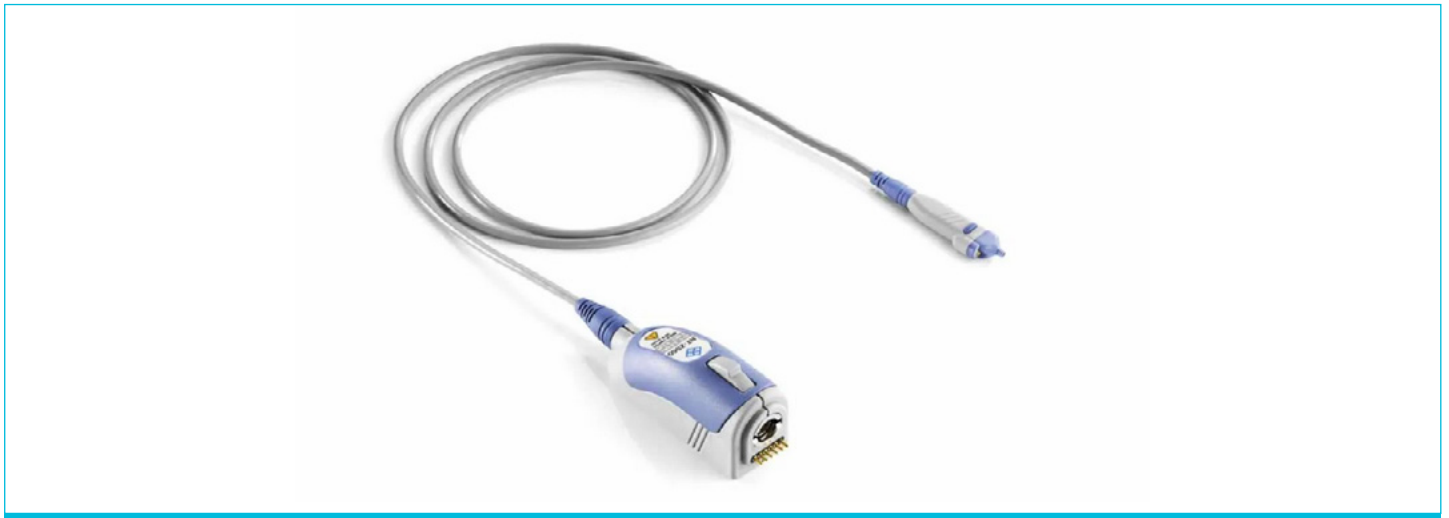
Bild 12. Der aktive Tastkopf RT-ZS 6 GHz von Rohde & Schwarz mit Mikrotaste wird zur genauen Messung von Signalen mit Masseverbindung verwendet. Er misst sowohl Hochgeschwindigkeits- als auch Niederfrequenzsignale, bei denen entscheidend ist, dass die Sonden-Impedanz nur eine minimale Last auf den Prüfpunkt legt. (Bild: RS Components)
