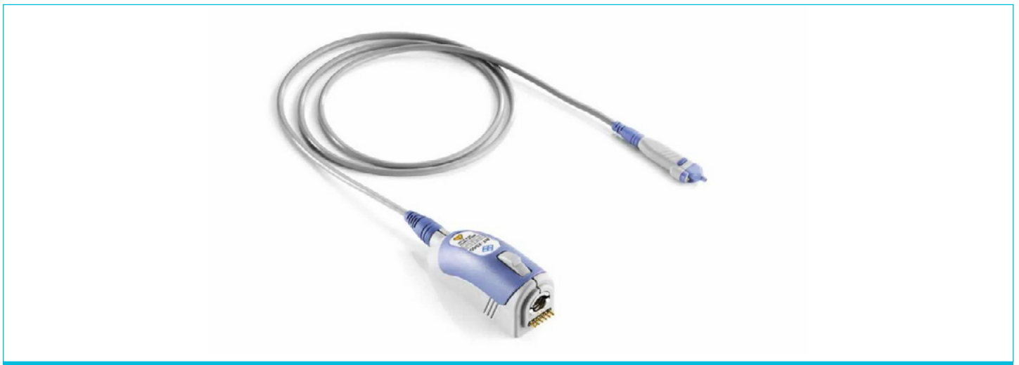
Bild 12. Der aktive Tastkopf RT-ZS 6 GHz von Rohde & Schwarz mit Mikrotaste wird zur genauen Messung von Signalen mit Mas-severbindung verwendet. Er misst sowohl Hochgeschwindigkeits- als auch Niederfrequenzsignale, bei denen entscheidend ist, dass die Sonden-Impedanz nur eine minimale Last auf den Prüfpunkt legt. (Bild: RS Components)
